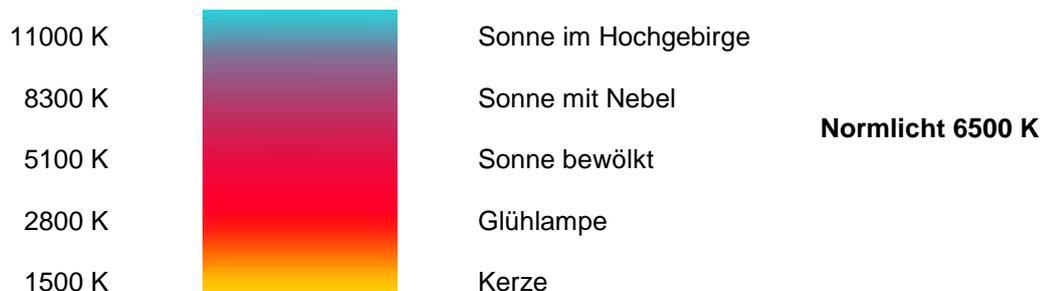
Abb. 6. Skala der Farbtemperaturen in ° Kelvin.
