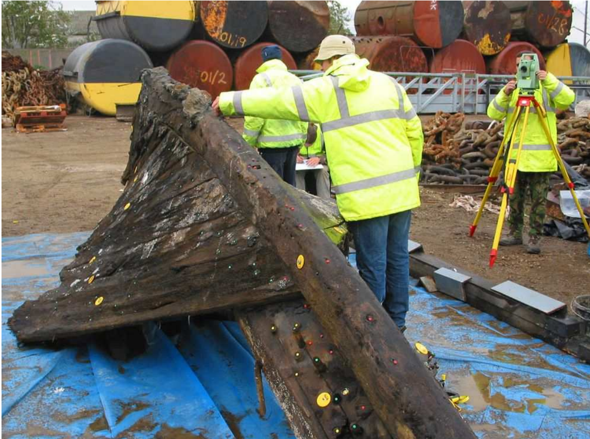
Abb. 9. Einsatz einer Totalstation zur Vermessung von gehobenen Wrackteilen. Auer 2004.
